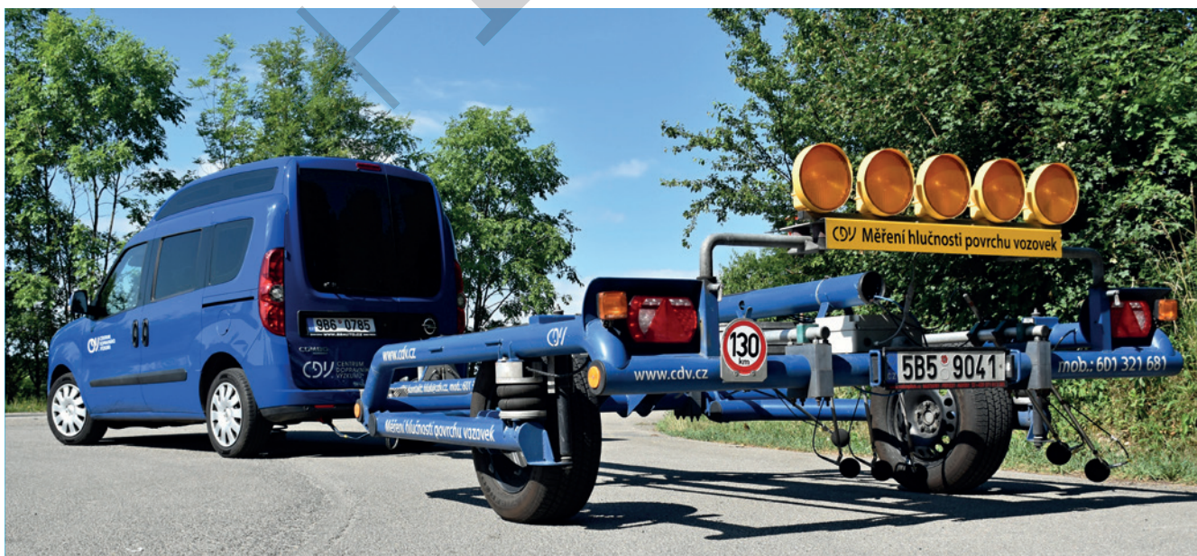
Obrázek 1: Měřicí zařízení CDV na sběr akustických dat pomocí metody CPX
