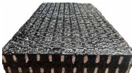
Obrázek 4: Vlevo – schematický příčný řez zkušebního trávce pro zkoušku stanovení odolnosti vůči únavě, vpravo – samolepicí mříž TAV 1 SAM instalovaná na střední asfaltovou vrstvu 2
